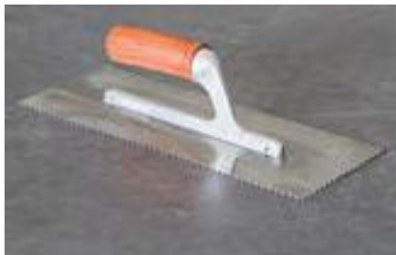
Шпатель со скошенными зубьями для нанесения клея на основание и шпатель с квадратными зубьями для обработки тыльной стороны плитки
